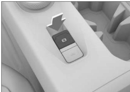
Con la chapa de contacto en modo ON, pise el pedal del freno y presione el interruptor EPB, y podrá liberar el freno de estacionamiento. En este punto, se apagará la luz indicadora de frenado de estacionamiento (Ⓢ) en el panel de instrumentos.
