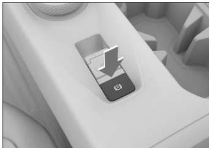
Cuando el vehículo está en una pendiente y se encuentra con una luz roja, o se detiene y se va, el estacionamiento automático (AVH) puede activar evitando que el conductor pise el pedal de freno durante mucho tiempo o aplique el freno de estacionamiento eléctrico con frecuencia. Haciendo que el conductor se sienta más cómodo y reduciendo el riesgo de que el vehículo deslice.
